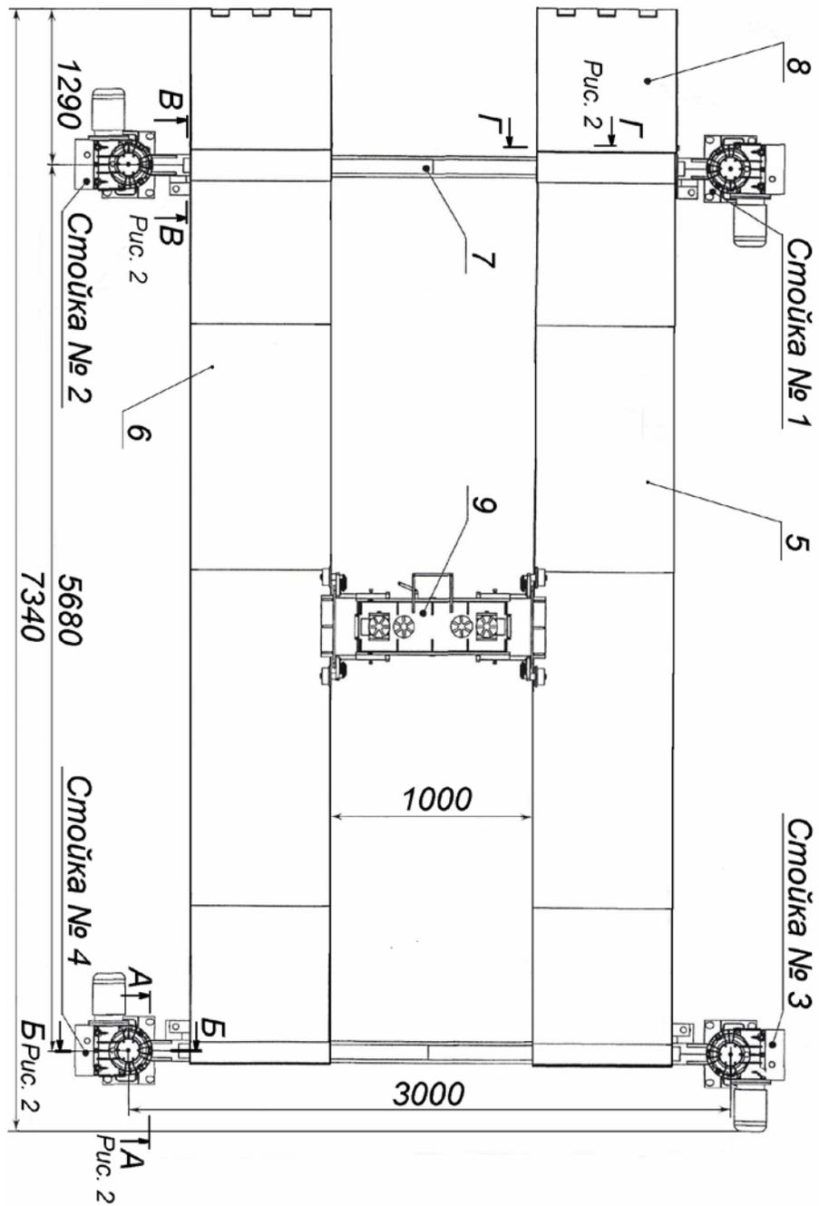
Рис. 1. Подъемник ПЛ15-30Н
