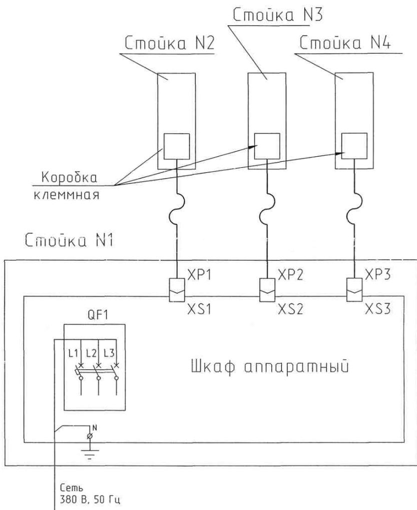
Рис. 5. Схема электрическая соединений подъемника ПЛ5-30Н
