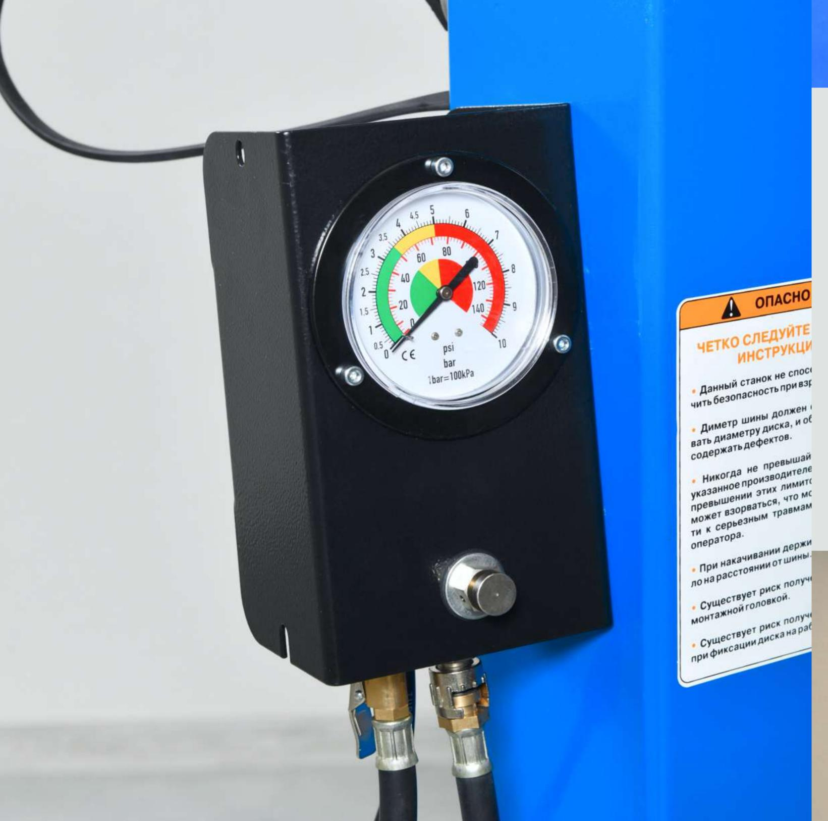
Система накачки оснащена ограничителем, настроенным на давление 3,5 бар, для безопасного накачивания колес
