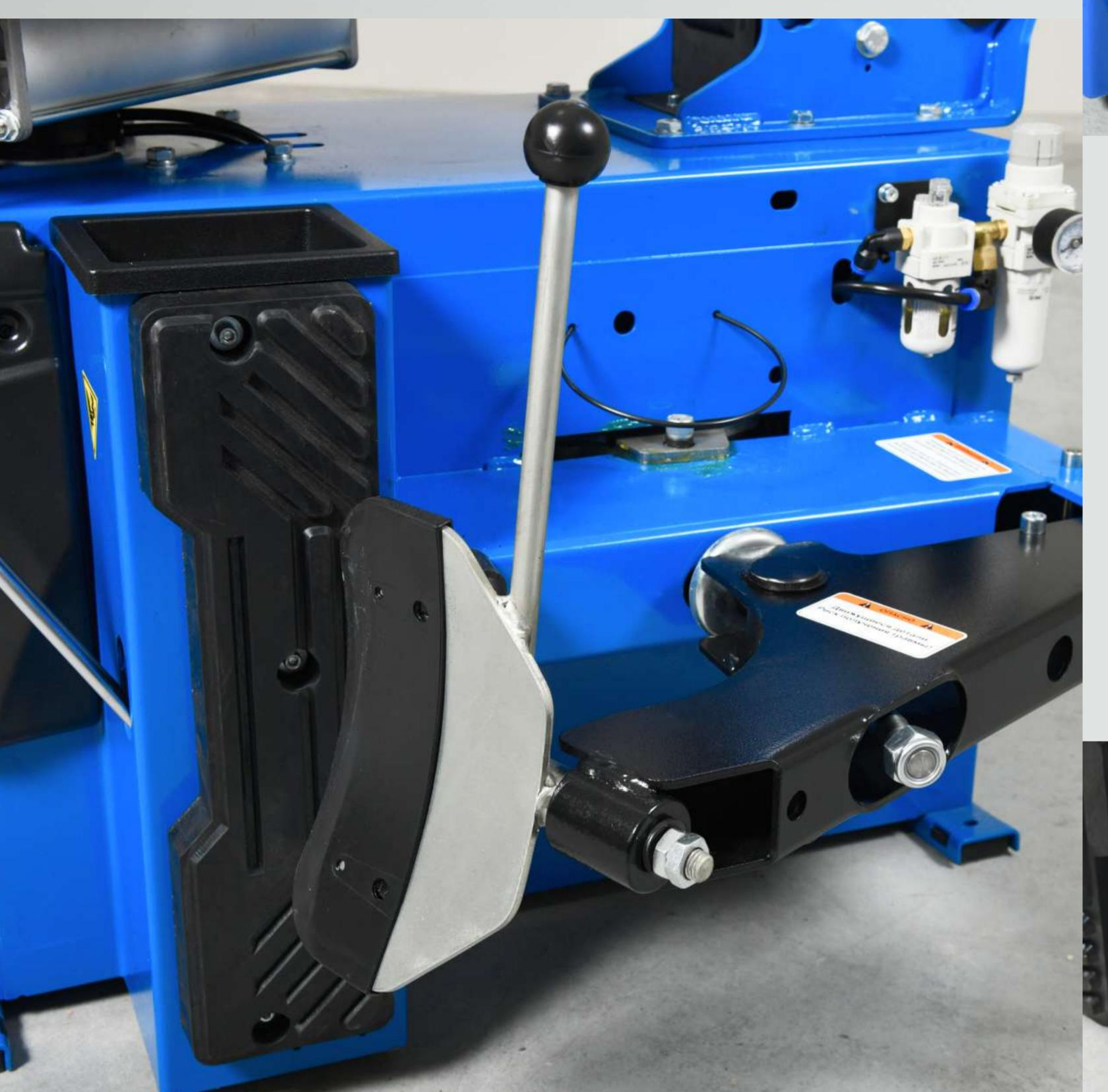
Конструкция площадки с износостойким резиновым упором позволяет производить отжим борта при любом положении рабочего стола без риска повреждения его механизмов и самого колеса
